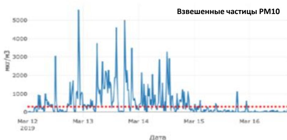
*Мониторинг показал эффективность системы пылеподавления - на границе СЗЗ концентрация мелкодисперсной пыли в 10 раз ниже предельно допустимого значения*
